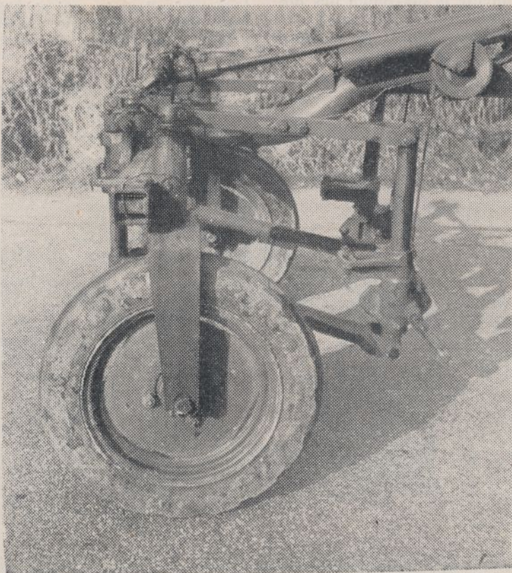
Vue latérale avec détail des bras d'attelage réglables, reliés au relevage pneumatique.
