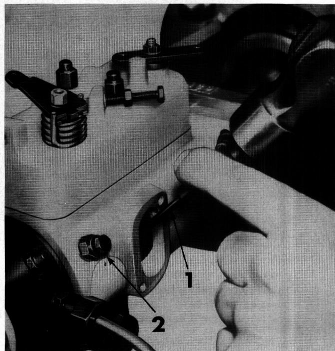
FIGURE 72 : Réglage de l'alimentation maximum — 1 = Outil N° CA 70, 2 = Vis de purge.
