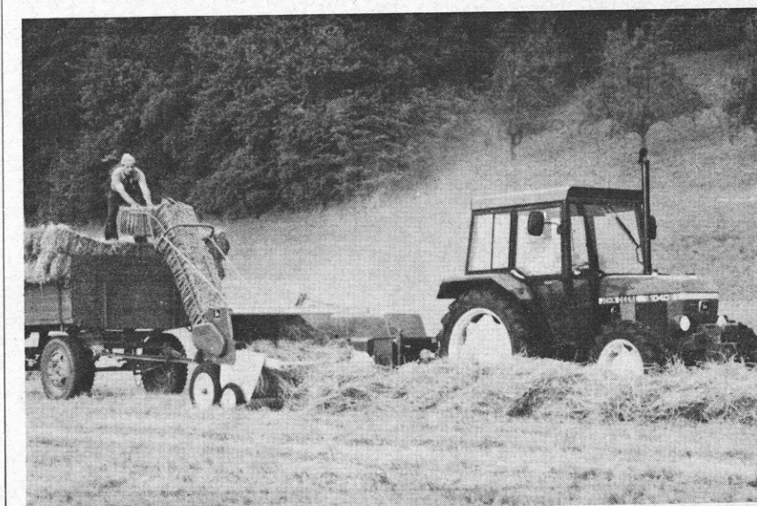
Grace à son canal de 31 × 41 cm la presse ramasseuse John Deere produit de petites balles
