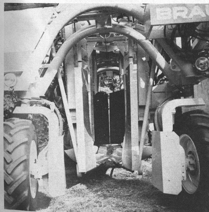
Tout l'équipement de vendange est suspendu sous un fort châssis réalisé en tubes ronds de 133 \times 8 mm et en tubes rectangulaires de 200 \times 100 mm.
