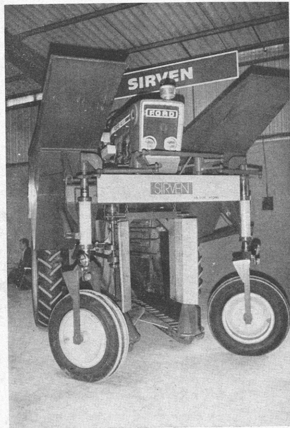
Une Sirven, montée sous enjambeur Ferrier et ici avec un ensemble propulseur de Ford 4100 (54 ch). Il s'agit du modèle AS 1700, conçu pour les vignes étroites et en gobelets. (Photo RTMA).
