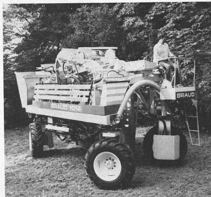
Vue d'ensemble de la Braud « 1014 » à 4 roues motrices et directrices.
