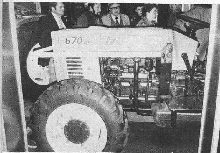
Gros plan du moteur Fiat « 8045-02 » équipant les « 670 », ici en version 4 roues motrices. A noter l'arceau de sécurité rabattu autour du capot moteur. (Photo RTMA).
