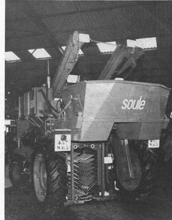
Deux vues du modèle « 100 H » permettant de voir le grand nombre de doigts vibrants. (Photo RTMA).
