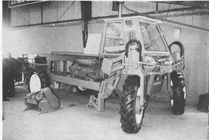
Si Loiseau ne présentait pas de nouveautés dans sa gamme traditionnelle, par contre il exposait un tracteur enjambeur 2 rangs qui a retenu l'attention. Réalisé pour un propriétaire à Chablis, ce matériel — très spécial — vaut 238 000 F. (Photo RTMA).
