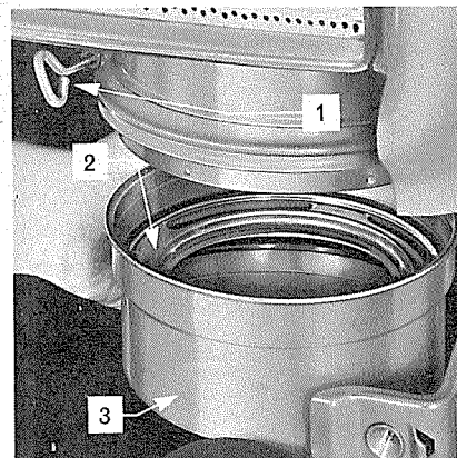
Figure 26 Dépose de la cuve du filtre à air 1. Vis à oreilles - 2. Coupelle intérieure - 3. Coupelle extérieure
