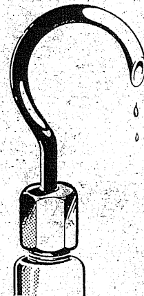
Col de cygne pour calage de la pompe Lavalette « M ».
