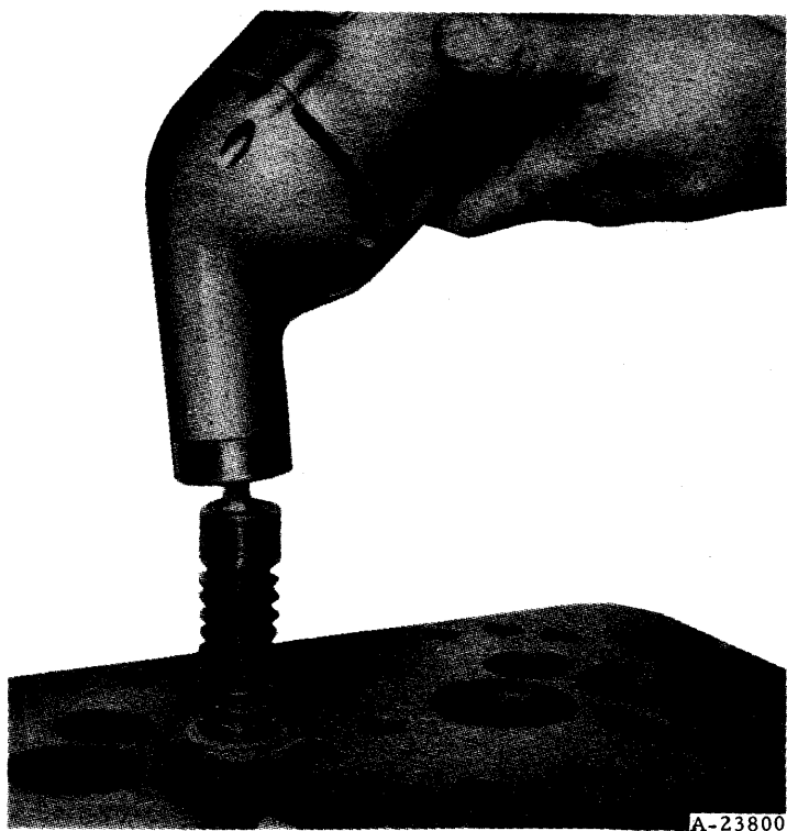
Fig. 31.- Rectification des sièges de soupapes
