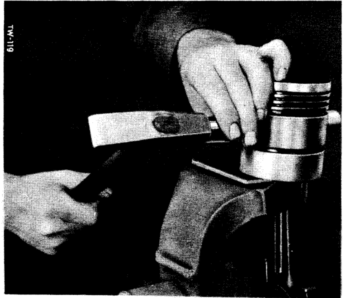
Fig. 52.- Démontage de l'axe de piston
