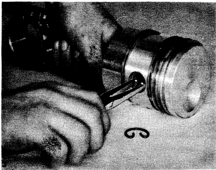
Fig. 51.- Dégagement de l'axe de piston
