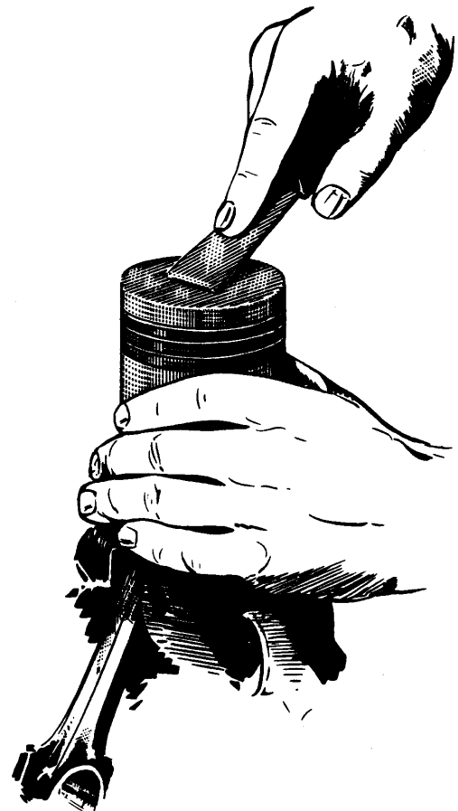
Fig. 42.- Nettoyage d'une tête de piston
