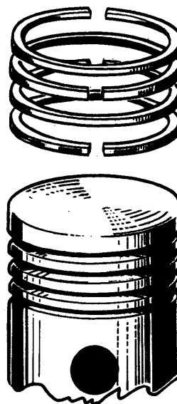
Fig. 74.- Disposition des segments au remontage
