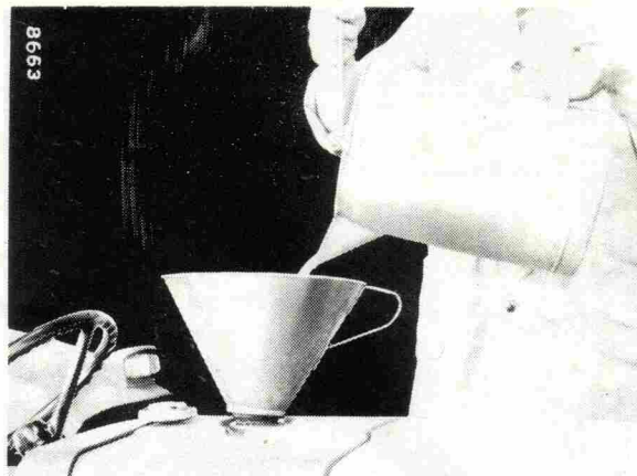
Fig. 44 Remplissage du réservoir à combustible
