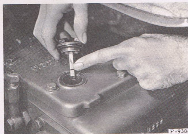
Fig. 34 A. — Jauge de niveau et orifice de remplissage du relevage hydraulique.
