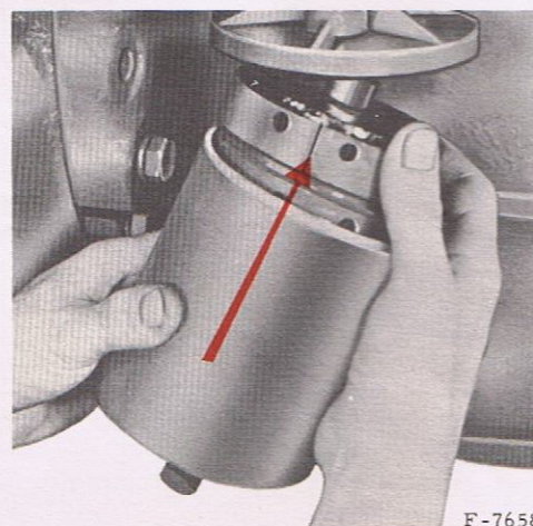
Fig. 15. — Dépose de l'élément filtrant d'huile.
