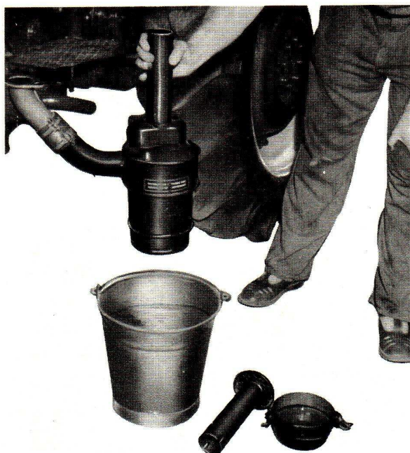
Fig. 38.- Nettoyage du filtre dans du combustible Diesel
