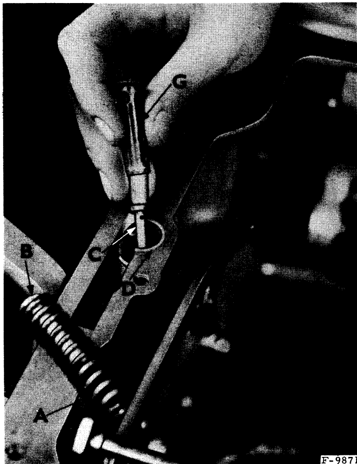
Fig. 27. - A. Ressort de clapet B. Clapet C. Soupape D. Chemise G. Aimant
