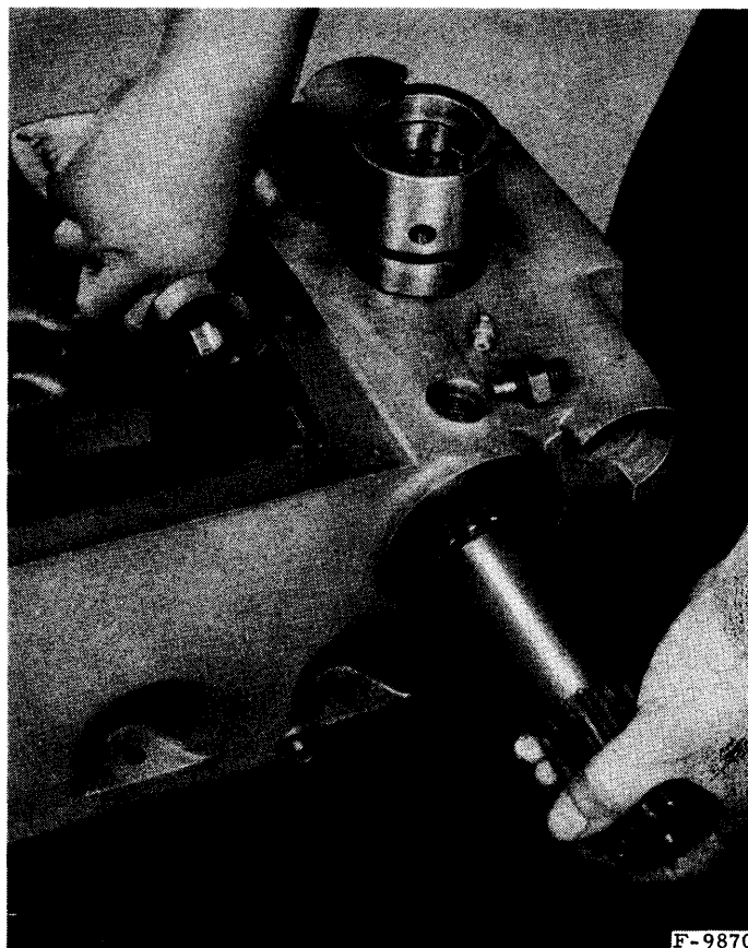
Fig. 26. - Dépose de l'arbre de relevage
