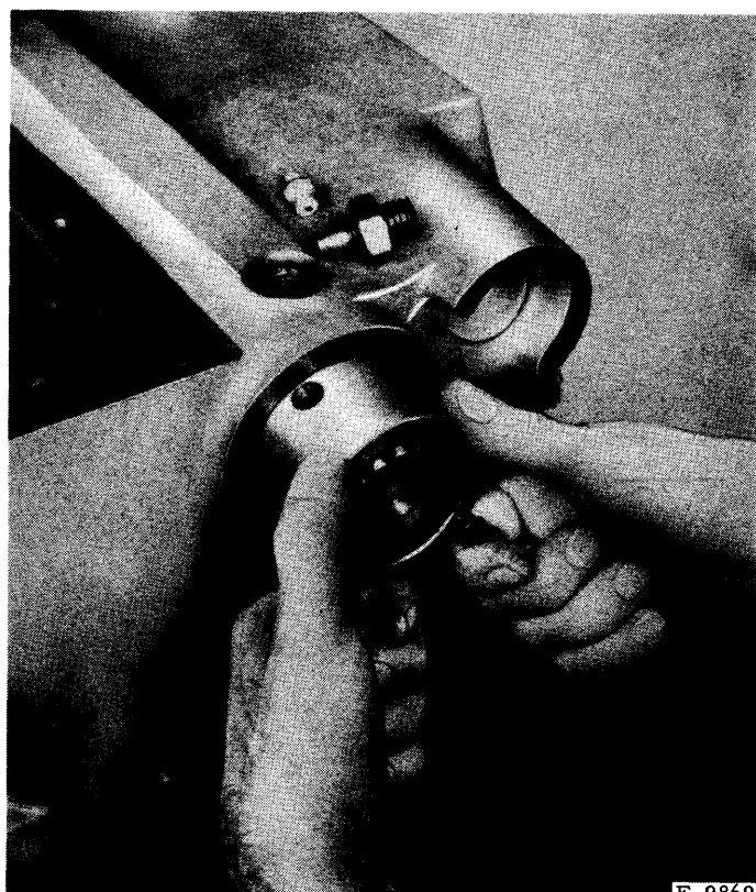
Fig. 25. - Extraction du manchon de friction
