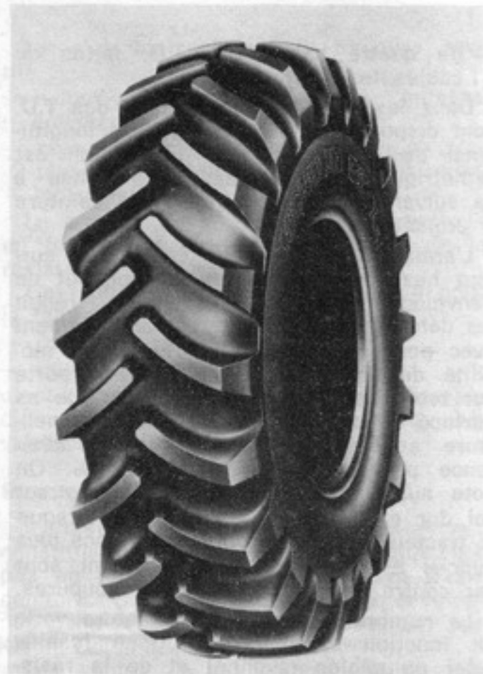
Exemple de pneu moteur, le Michelin « Bib' XM 8 » avec les épaules de crampon en forme de coin et ses larges couloirs d'évacuation
