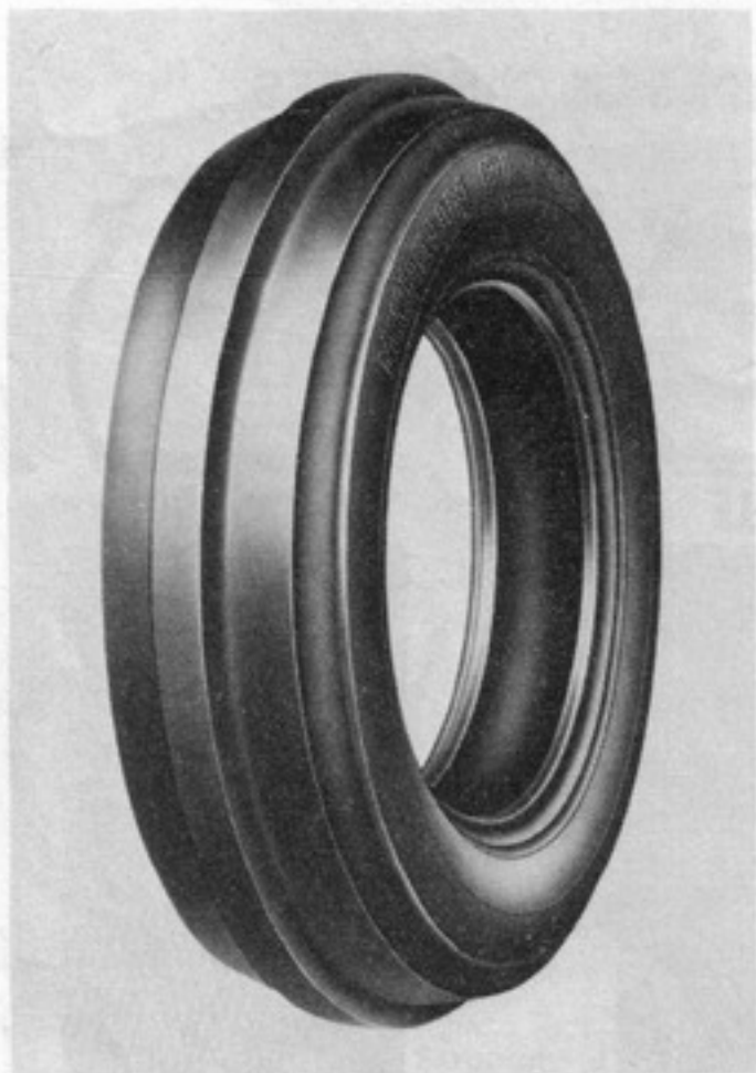
Exemple de pneu directeur. Ici un Michelin « Bibguid » avec sa nervure unique pour faciliter le guidage en terrain gras
