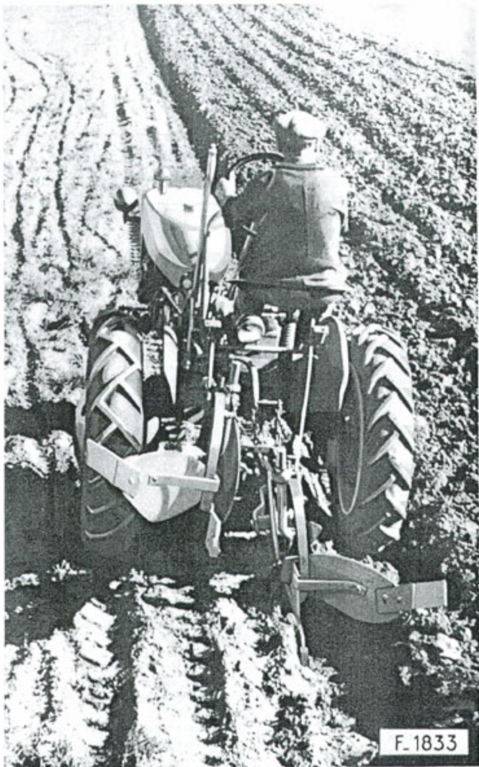
Ci-contre: Farmall Super CUB au travail avec la Charrue portée alternative CUB P-189.
