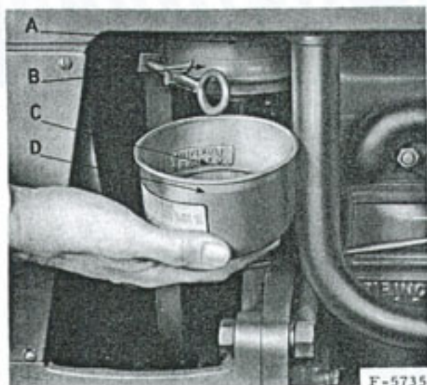
Figure 29 - Démontage du bol du filtre à air A. Filtre à air - B. Collier de serrage - C. Niveau d'huile - D. Bol du filtre à huile
