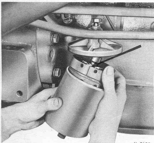
Fig. 23. — Dépose de l'élément filtrant d'huile
