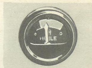
Figure 5B - Manomètre de pression d'huile montrant l'aiguille en position correcte de fonctionnement.
