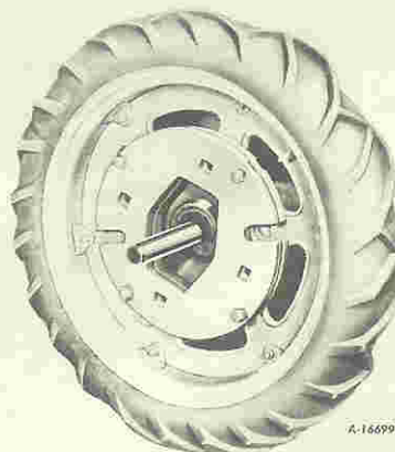
Figure 59C - Premier et deuxième poids de roue arrière fixés sur roue.
