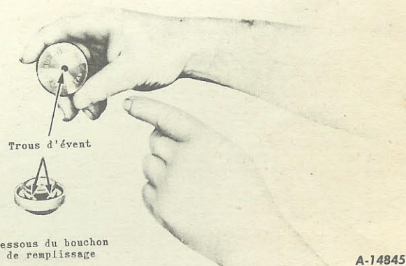
Figure 7 - Trous d'évent dans le bouchon de remplissage.
