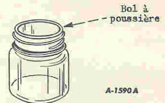
Figure 58A - Filtre à air préliminaire (type à collecteur) démonté pour le nettoyage.
