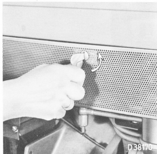
Figure 113 : Démontage de la grille latérale
