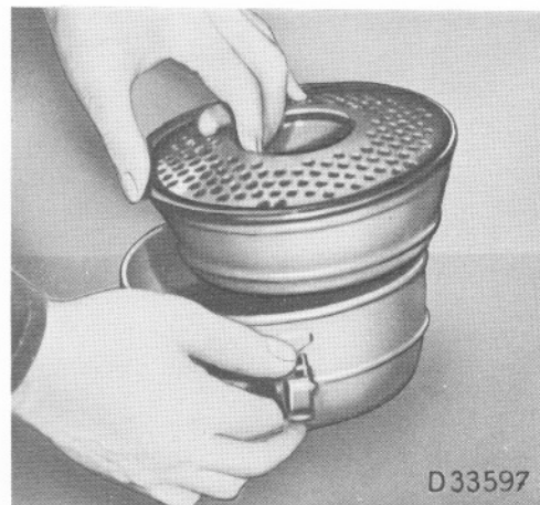
Figure 123 : Démontage de l'élément filtrant inférieur du filtre à air
