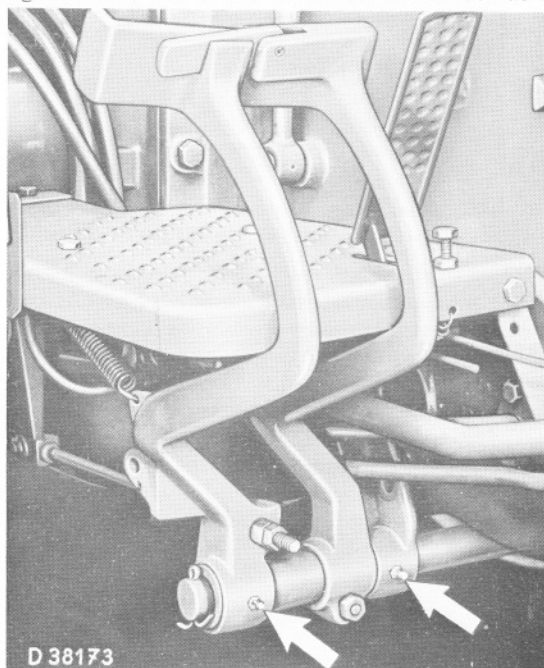
Figure 139 : Points de graissage du palier droit de l'arbre des pédales de frein et des pédales de frein
