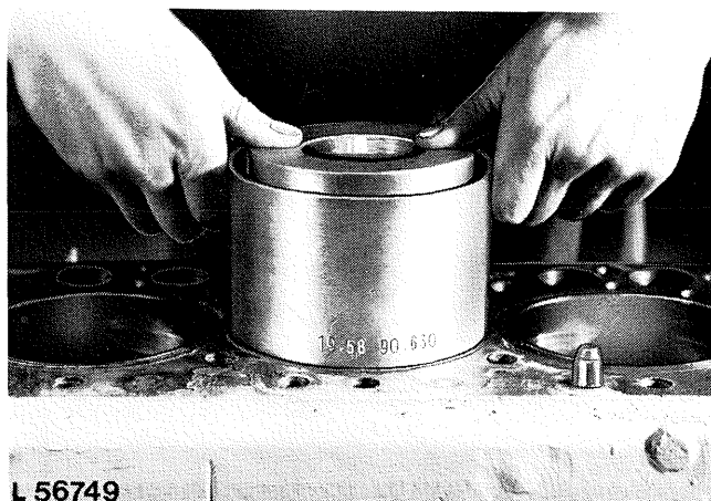
Fig. 7 — Repose des pistons à l'aide de l'outil spécial n° JD 19.58-90.630
