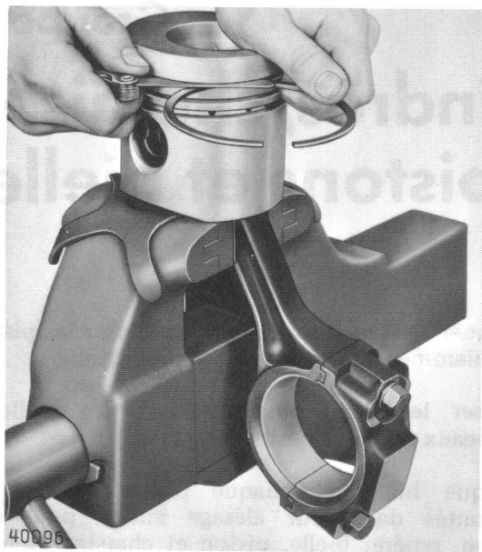
Fig. 1 — Mesure du jeu de segments dans leurs gorges.
