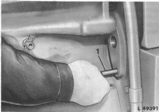
Fig. 7 — Utilisation de la vis de réglage pour déterminer le PMH
