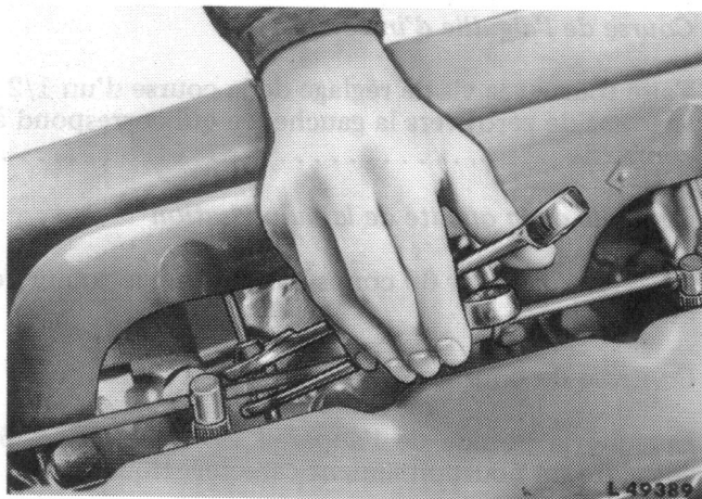
Fig. 17 — Serrage d'une conduite sous pression
