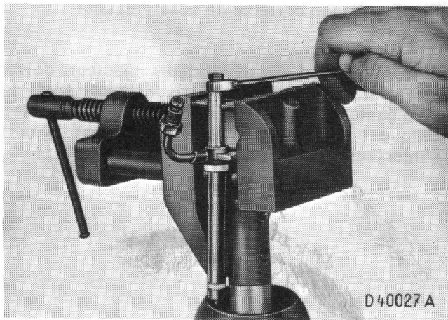
Fig. 7 — Desserrage du contre-écrou des vis de réglage
