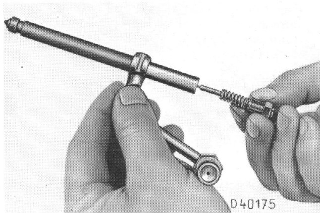
Fig. 15 — Remontage de l'injecteur
