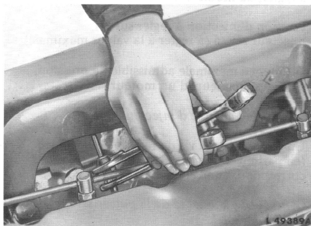
Fig. 17 — Serrage d'une conduite sous pression
