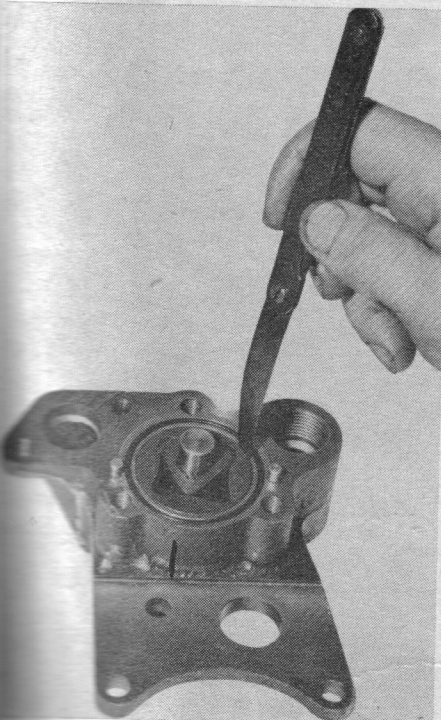
Contrôle du jeu entre rotor extérieur et corps de pompe.
