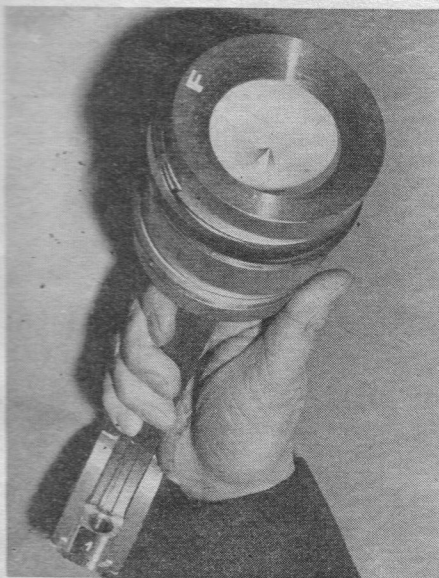
Repères d'assemblage du piston et de la bielle des moteurs à injection directe. Les repères sont identiques pour les moteurs à préchambre.
