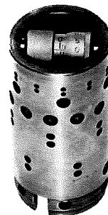
Fig. 160 - Contrôle du diamètre du corps extérieur du distributeur à l'aide du calibre micrométrique pour diamètres intérieurs.
