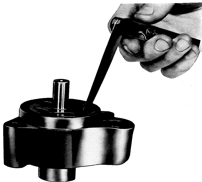
Fig. 36 - Contrôle du jeu entre le rotor externe et son logement dans le corps de la pompe à huile à l'aide du jeu de cales 5.9030.270.0.
