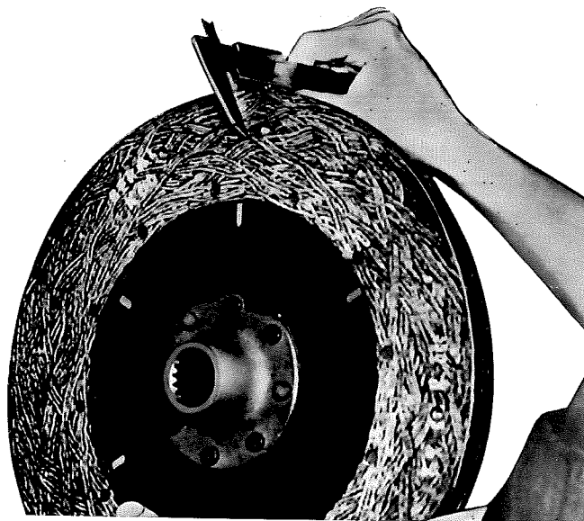
Fig. 64 - Mesure de l'épaisseur du disque d'embrayage avec le calibre 5.9030.271.0.
