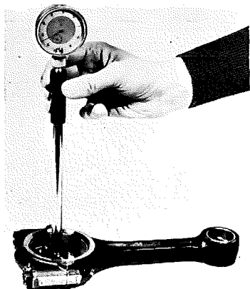
Fig. 19 - Contrôle du diamètre intérieur des demi-coussinets de bielle à l'aide de l'instrument 5.9030.022.0.
