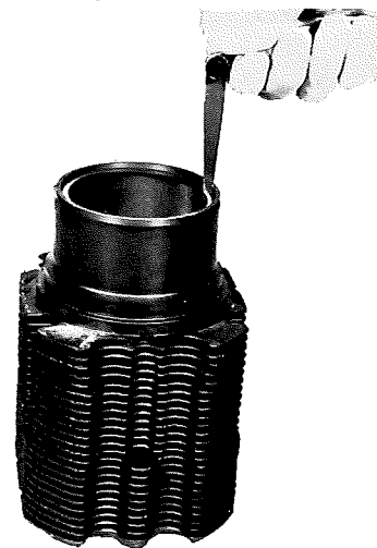
Fig. 25 - Contrôle du jeu de la coupe des segments introduits dans le cylindre à l'aide du jeu de cales d'épaisseur 5.9030.270.0.
